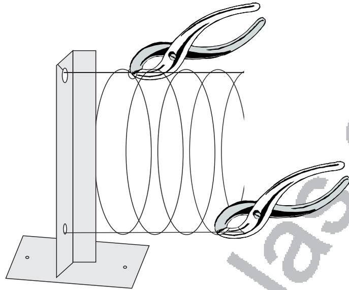
Feito isto trave o fio tensor superior nos postes do meio conforme mostra a figura. No detalhe A, observe que os postes de fixação possuem um corte, com a ajuda de um alicate abra a ponta
