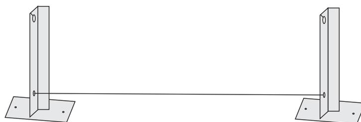
Na sequência apoie a concertina sobre o tensor 1 e através do rolo passe o tensor 2 sem soltar o rolo, que deverá ser solto após ter sido passado o tensor 2
