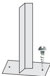
Com as buchas colocadas no lugar fixe as hastes (postes) usando parafusos.
